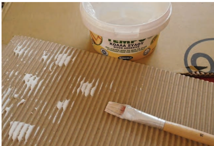
ΕΙΚΟΝΑ 13. Άπλωμα της κόλλας στη ριγωτή πλευρά του χαρτονιού.
